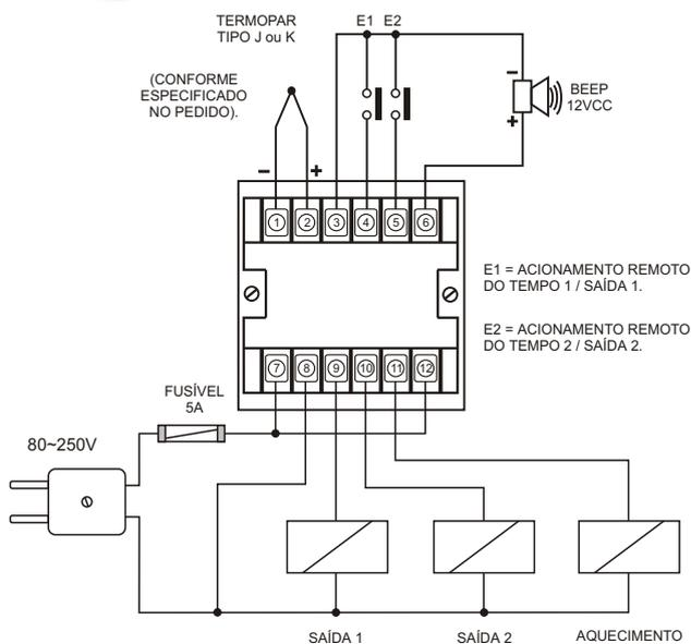
OBS.: QUANDO O CONTROLADOR POSSUIR CONECTORES, OS TERMINAIS DOS CONECTORES OBEDECEM A MESMA NUMERAÇÃO DO ESQUEMA DE LIGAÇÃO DOS TERMINAIS DA TAMPA.
