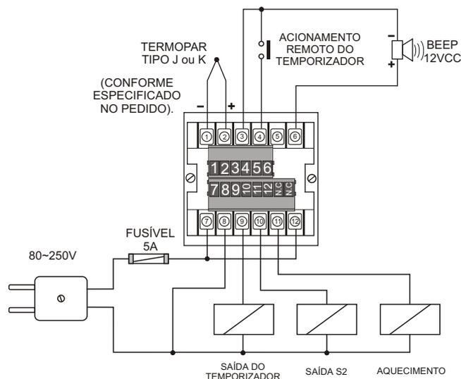
A SAÍDA S2, EM FORNOS DE PANIFICAÇÃO, É UTILIZADA PARA ACIONAMENTO DO VAPOR.
